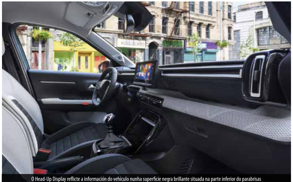
O Head-Up Display reflicte a información do vehículo nunha superficie negra brillante situada na parte inferior do parabrisas
